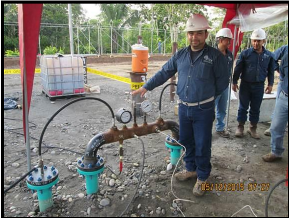
Prueba hidrostática Plataforma Tiputini B
