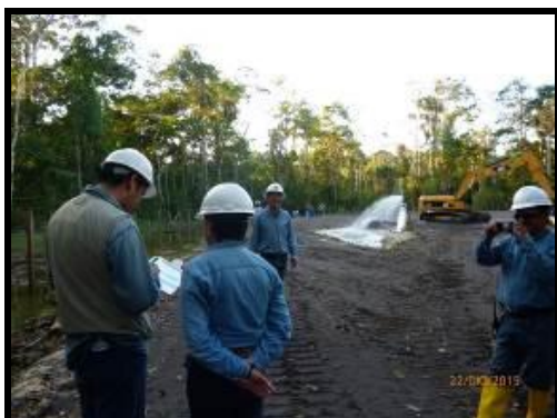
Prueba hidrostática (PH) cruce subfluvial con MAE
