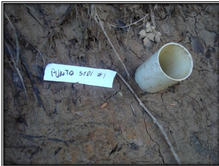
Fotografía N° 3.3.61.- Toma de muestras de suelo con colector vertical
