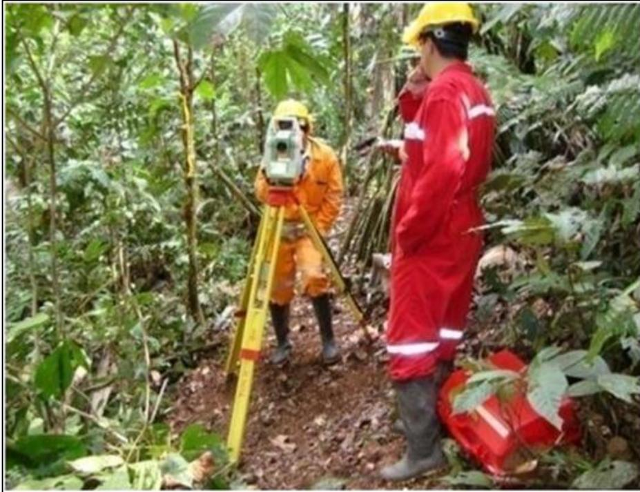
La fotografía muestra los trabajos de topografía para señalar líneas sísmicas Sísmica realizada con Licencia Ambiental emitida en el 2011.
