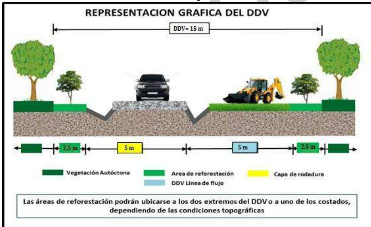
Ilustración 4-4: Presentación gráfica del Derecho de Vía de Línea de Flujo y Acceso Ecológico
